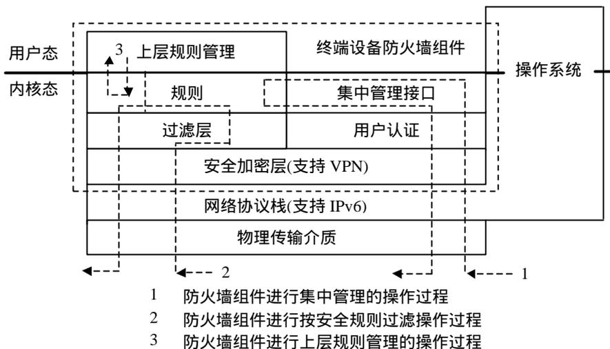
图 5.7 终端防火墙组件层次功能技术模型图
