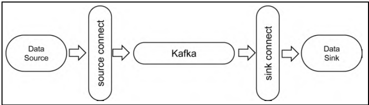
图 10.2 Kafka Connect 架构图
