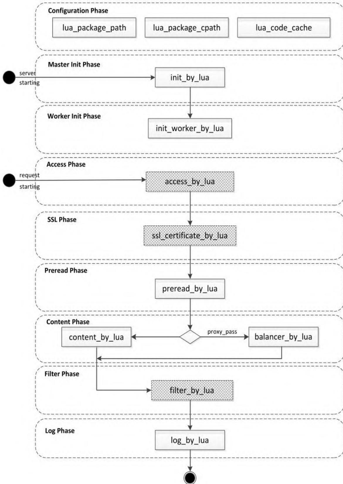
图14-1 stream子系统里的处理阶段和指令的先后顺序
