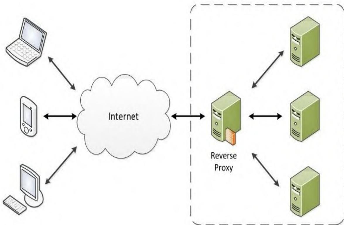
图2-2 反向代理的网络结构
