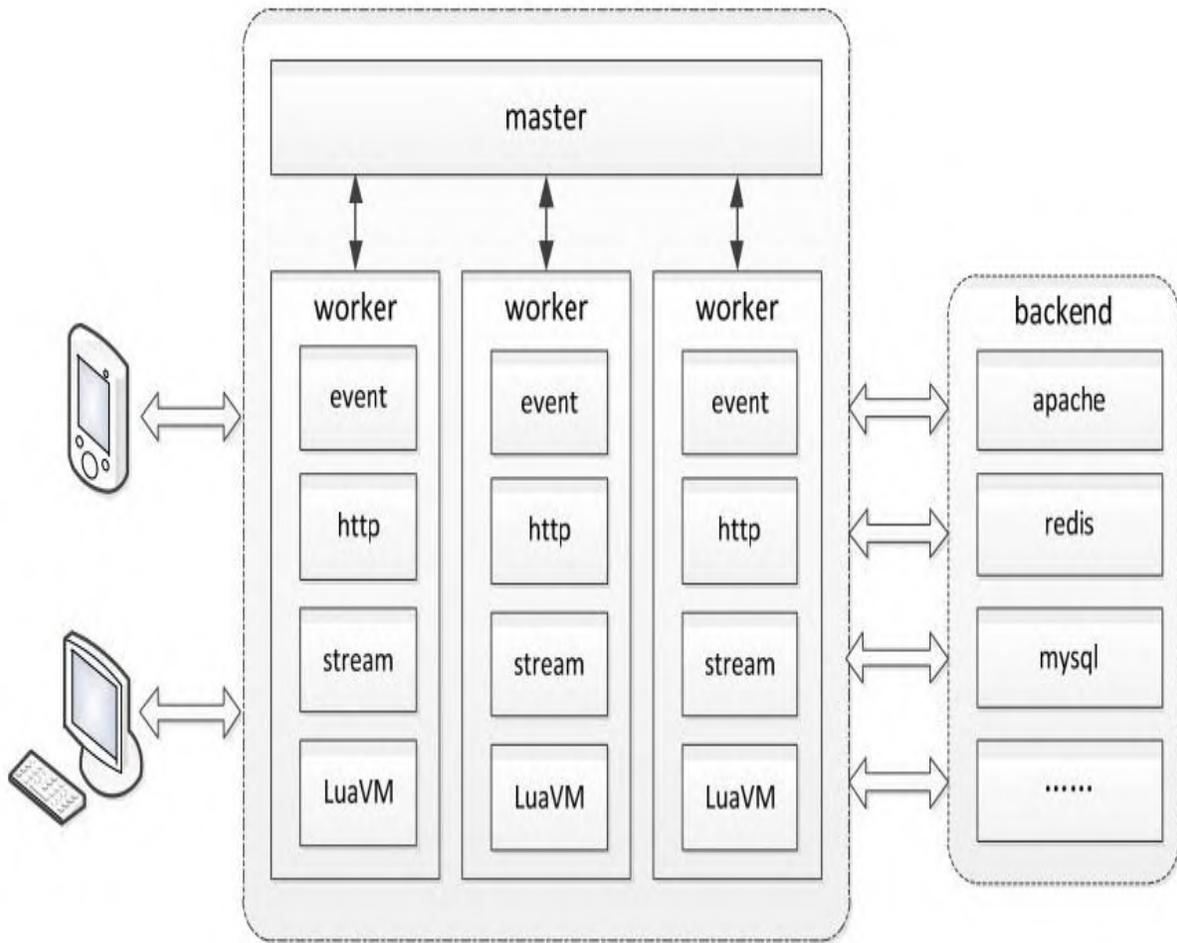
图2-1 Nginx的进程模型
