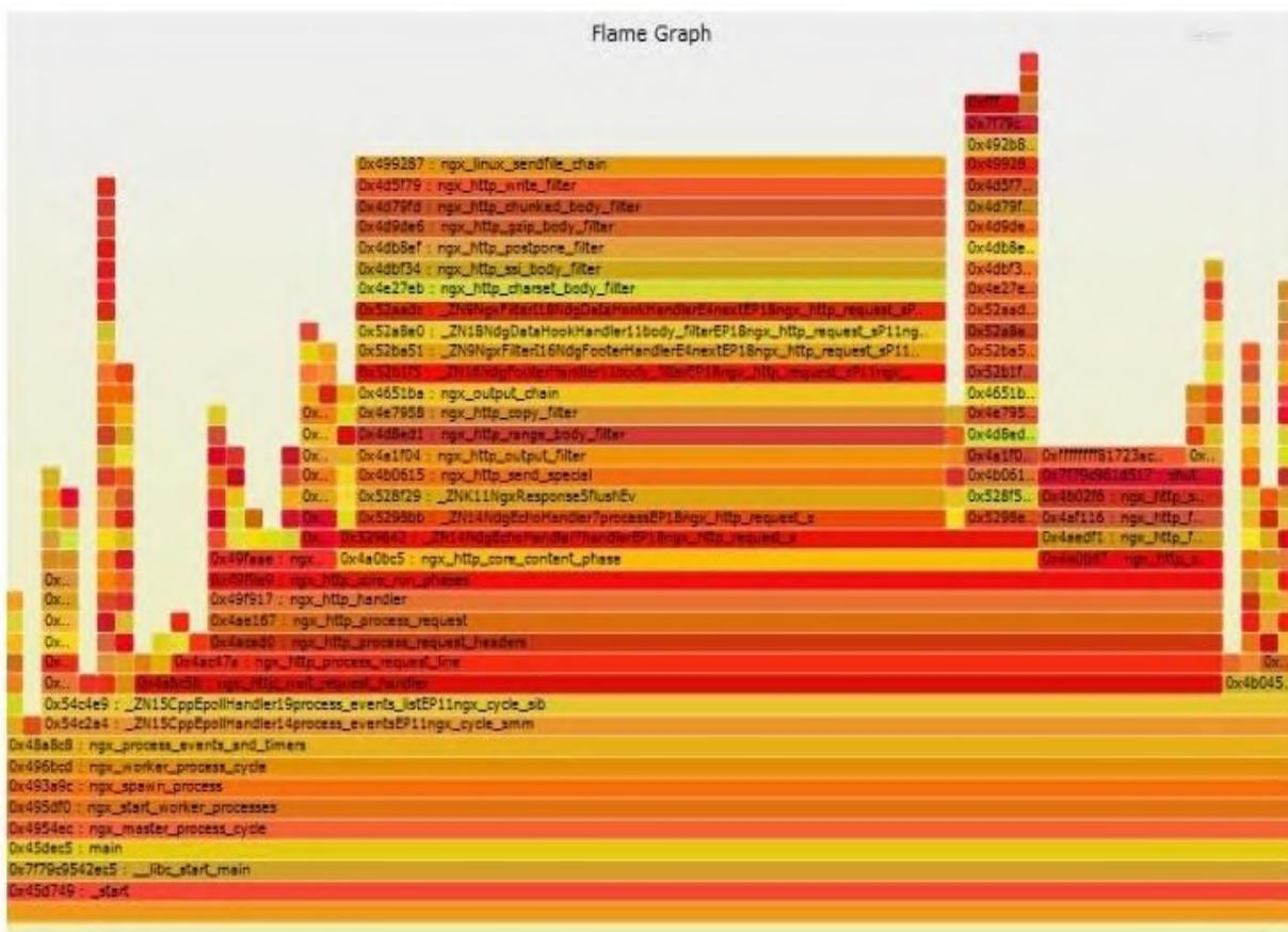
图15-1 火焰图示例
