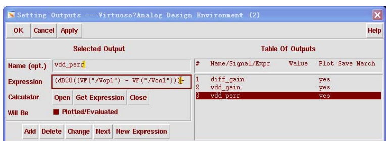
图 7-45 电源抑制比的表达式设定
