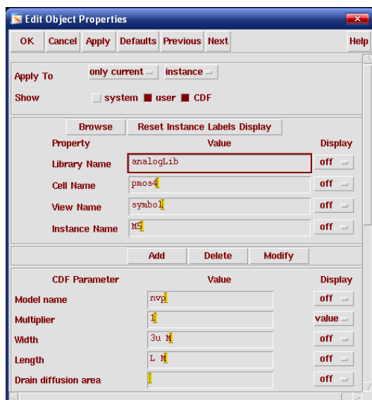
图 9-29 将 PMOS 的栅长设置为变量“ L ”
