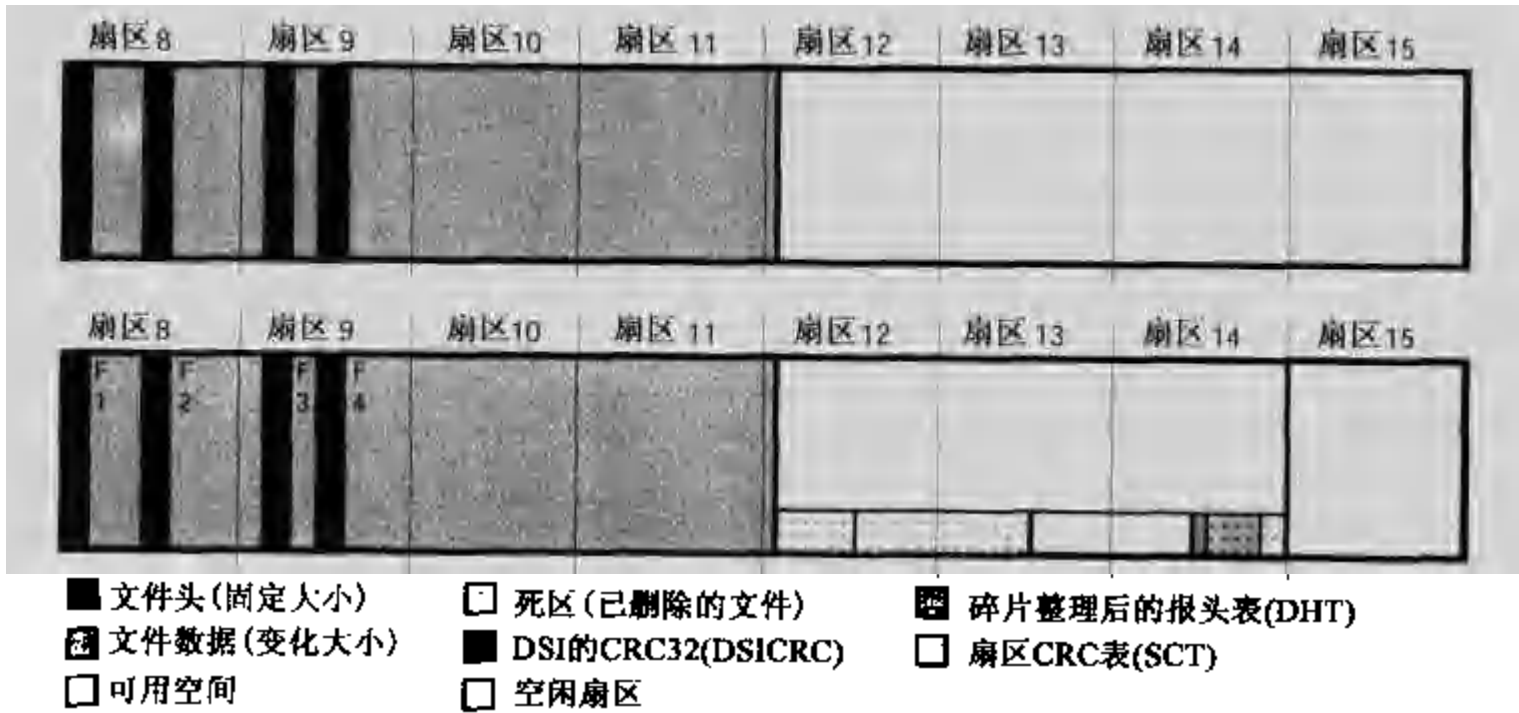
图 7.10 清除操作及碎片整理操作的完成
