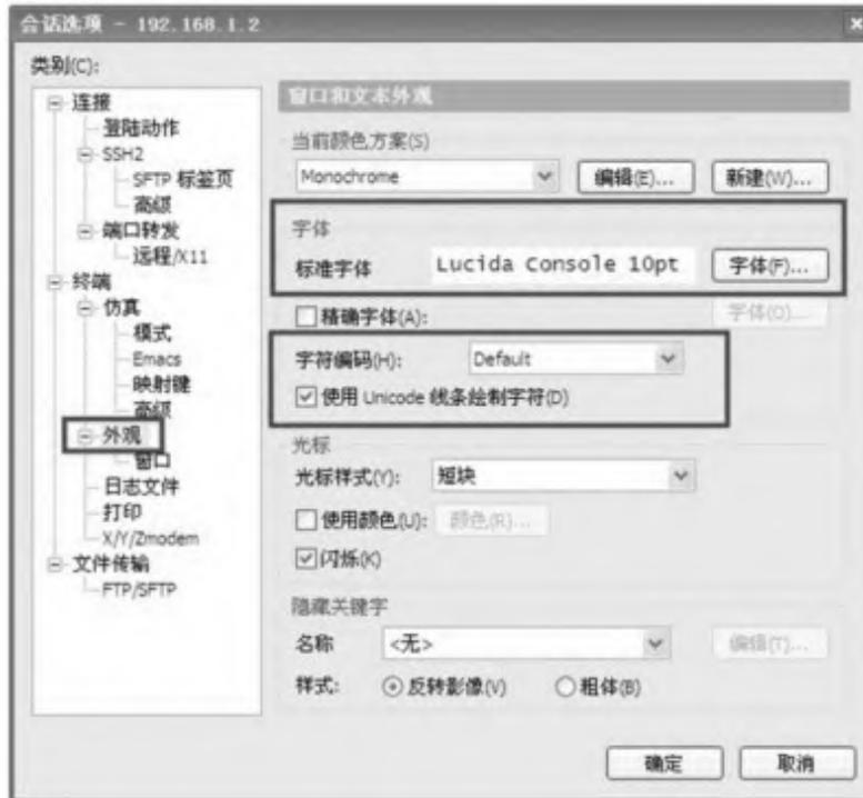
图1.6 SecureCRT字符编码配置
