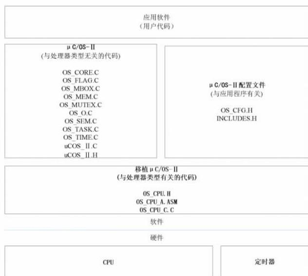
图1  $\mu$ C/OS-II 硬件/软件结构图
