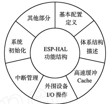
图 4 ESP-HAL 功能结构示意图
