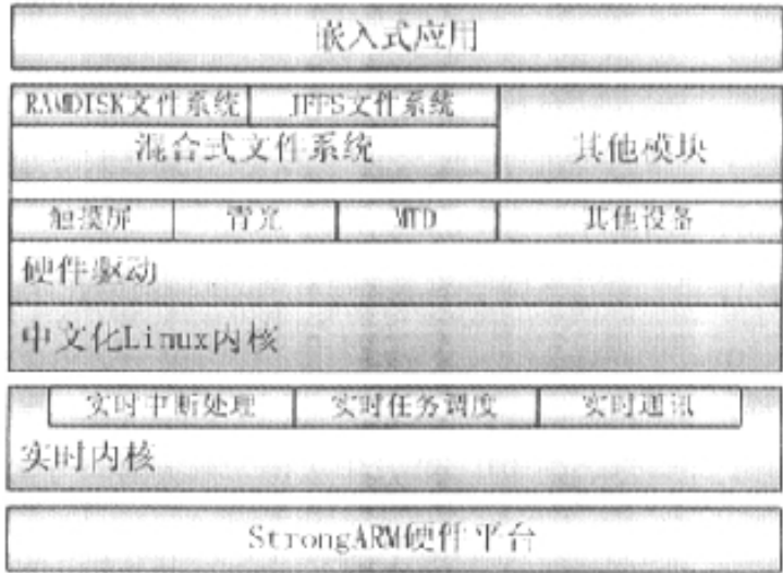
图 4-3 StrongARM 平台上的 LEOS 系统结构图
