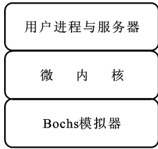
图 1 系统逻辑结构示意图
