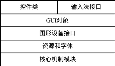
图2 核心图形操作层结构图
