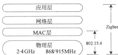
图1 Zigbee 协议栈架构
