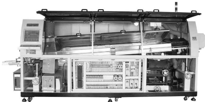
图 5-4 波峰焊机结构
