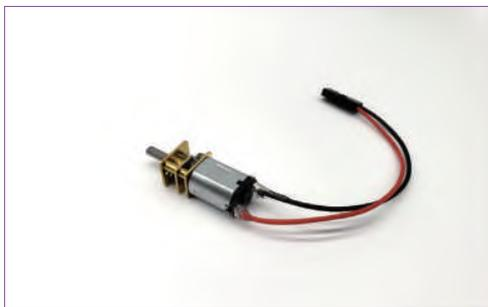
图 1.6 电机是机器人最典型的执行单元
