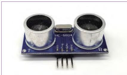
图 1.4 超声波传感器可以用于测距
