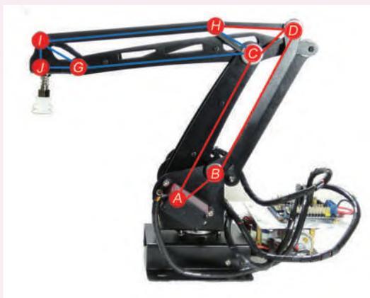
图 6.5 机械臂的机械结构
