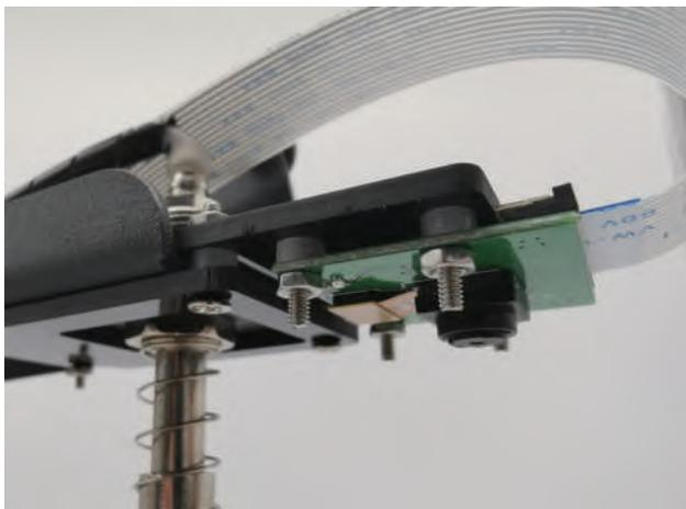
图 6.19 已安装摄像头的机械臂
