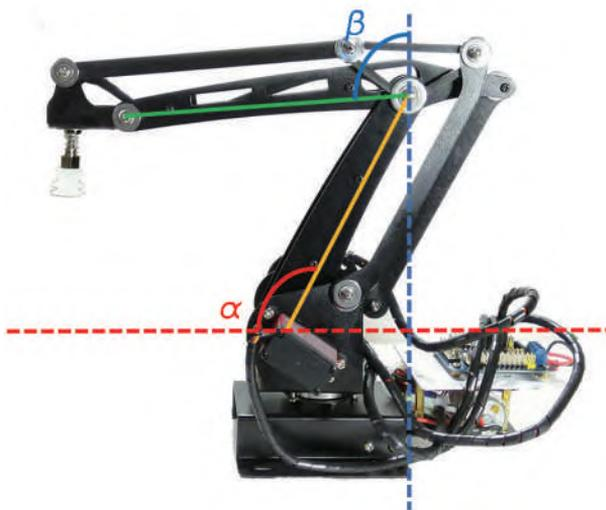
图 6.3 机械臂两个转轴与水平线、垂直线的夹角等同于舵机的角度
