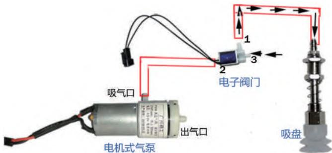
图 6.12 电子阀门通电时的气流方向示意图
