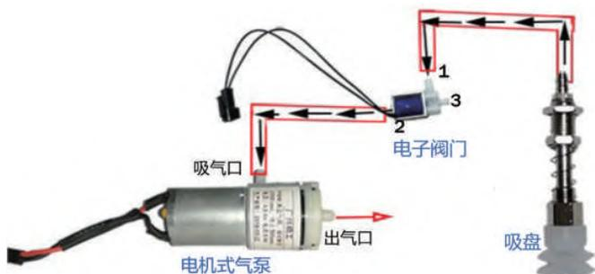
图 6.11 气泵抽气时的气流方向示意图
