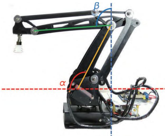
图 6.24 机械臂舵机角度与转轴角度对应关系回顾
