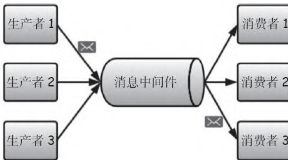
图8-1 消息中间件点对点模式的工作原理
