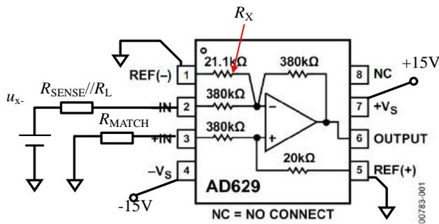
图 Section65-33b 叠加原理之  $u_{x-}$  输入状态
