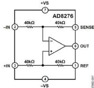
图 Section65-5：集成差动放大器器 AD8276
