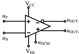
图 Section72-2 全差分运放管脚结构图
