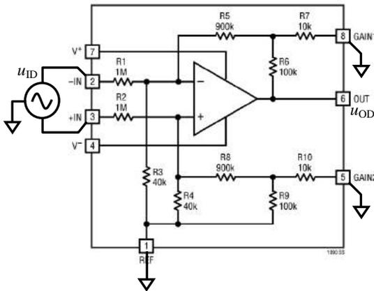
图 Section65-39 LT1990 的差模输入，G=10
