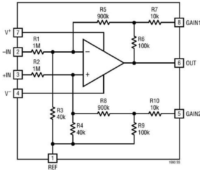
图 Section65-36 内含精密电阻的 LT1990
