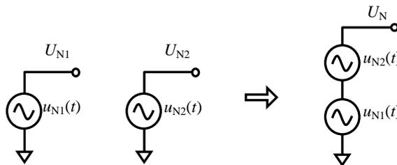
图 Section71-1 噪声叠加原理
