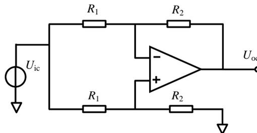
图 Section70-3 共模抑制比演示电路
