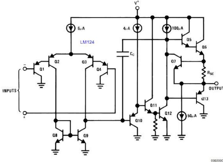
图 Section69-3 LM124 简化结构图
