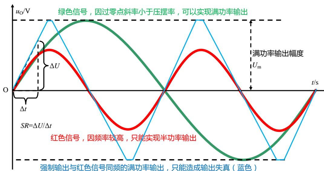
图 Section70-5 压摆率与满功率带宽示意图
