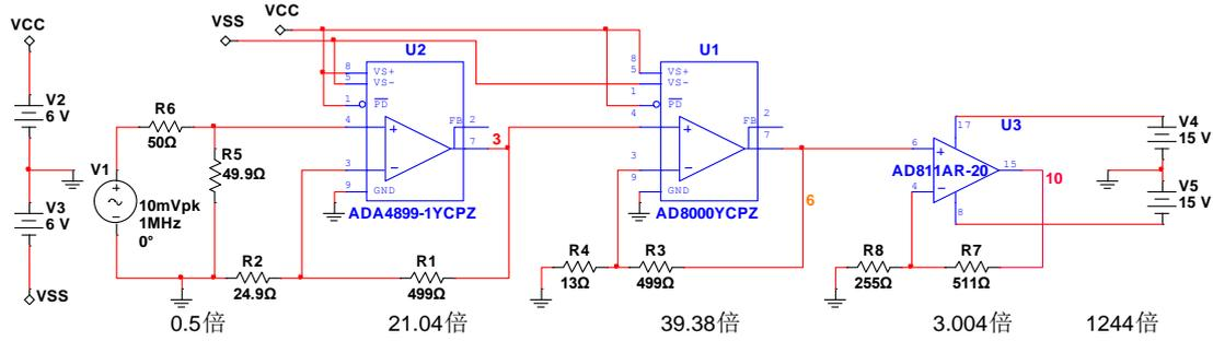
图 Section73-6 举例 3 放大电路
