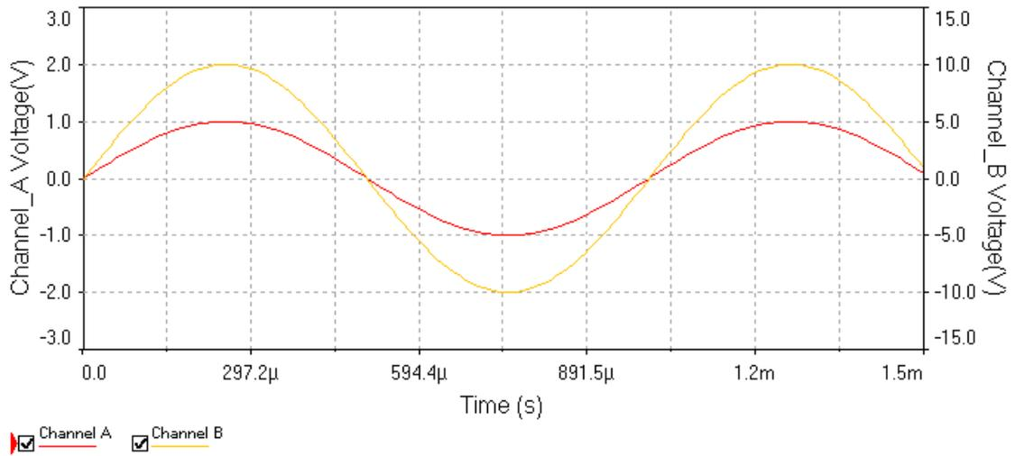
图 Section68-5 10 倍同相比例器输入输出波形
