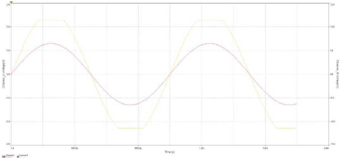
图 Section68-7 10 倍同相比例器输出失真波形
