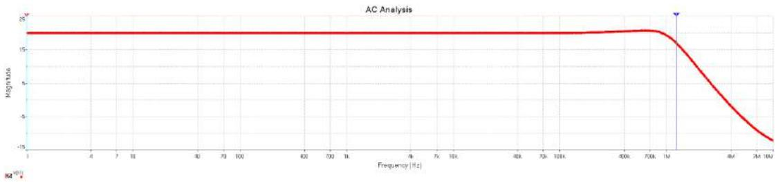
图 Section68-6 10 倍同相比例器的幅频特性
