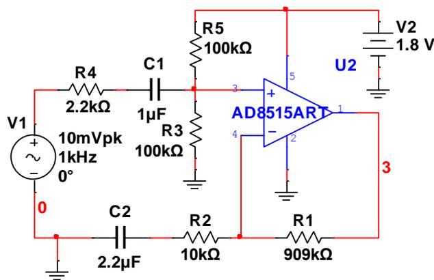
图 Section73-1 举例 1 放大电路
