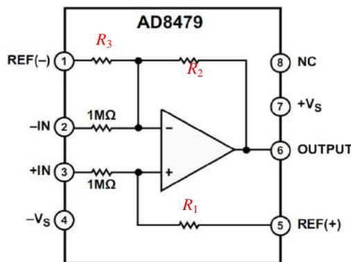
图 Section65-34 AD8479 内部结构示意图
