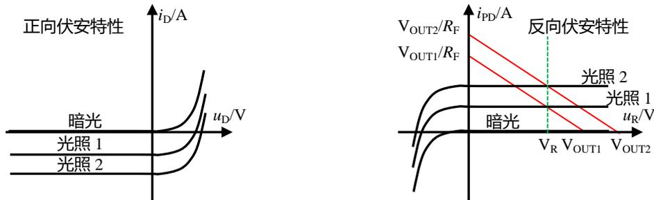
图 Section65-23 光电二极管伏安特性曲线示意图
