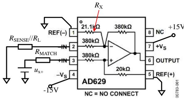
图 Section65-33a 叠加原理之  $u_{x+}$  输入状态
