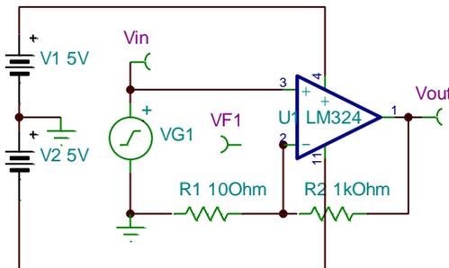
图 Section70-1a 失调电压举例电路 1
