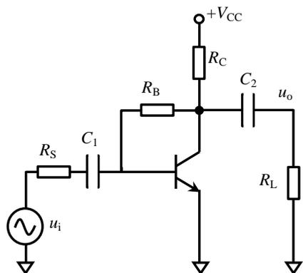
图 Section67-1 单管含反馈放大电路
