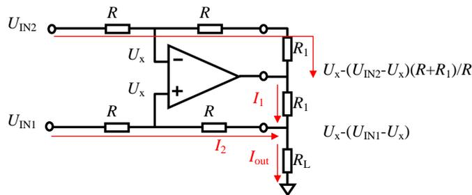
图 Section65-12 基于差动放大器的压流转换器(电流源)
