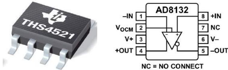
图 Section72-1 全差分运算放大器外形、管脚图示意
