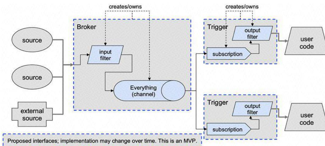
这里介绍一下 Eventing 中 Broker/Trigger 模型，其实并不复杂。外部事件源将事件发送给 Broker，Broker 接收事件之后发送给对应的 Channel（也就是消息缓存，转发的地方，如 Kafka，InMemoryChannel 等），通过创建 Trigger 订阅 Broker 实现事件的订阅，另外在 Trigger 中定义对应的服务，实现最终的事件驱动服务。
