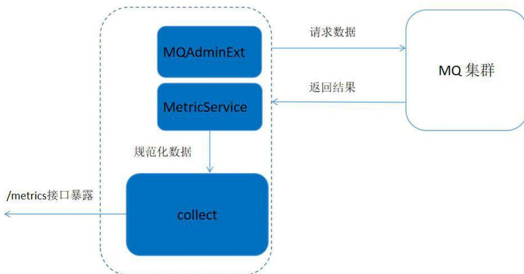
整个系统基于 spring boot 框架来实现。由于 MQ 内部本身提供了比较全面的数据统计信息，所以对于 Exporter 而言，只需要将 MQ 集群提供的统计信息取出然后进行加工而已。所以 RocketMQ-Exporter 的基本逻辑是内部启动多个定时任务周期性的从 MQ 集群拉取数据，然后将数据规范化后通过端点暴露给 Prometheus 即可。其中主要包含如下主要的三个功能部分：
