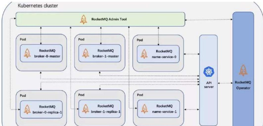
整体的实现方案如上图所示，通过自定义的 CRD 对消息中间件的业务模型进行抽象，将原有的在中间件部署平台的业务发布部署逻辑下沉到消息中间件自己的 operator 中，托管在内部 Kubernetes 平台上。该平台负责所有的容器生产、初始化以及集团内一切线上环境的基线部署，屏蔽掉 IaaS 层的所有细节。
