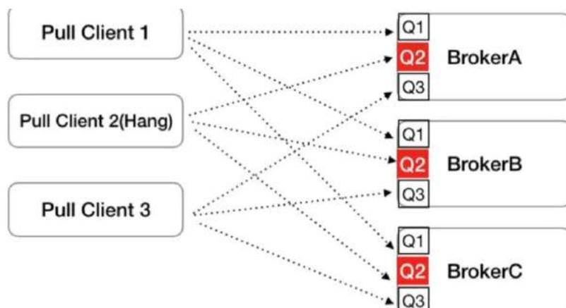
当 Pull Client 2 发生 hang 机器的时候，它所分配到的三个 Broker 上的 Q2 都出现严重的红色堆积。对于此，我们增加了一种新的消费模型——POP 消费，能够解决此类稳定性问题。如下图所示：
