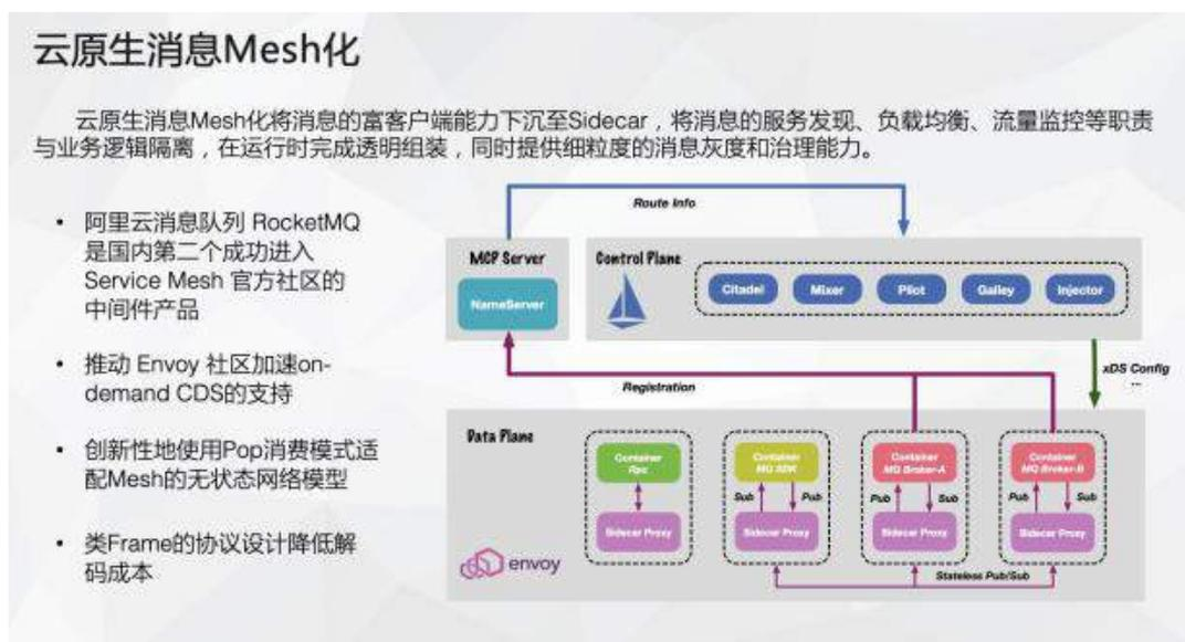
Service Mesh 出发点是解决微服务架构的网络问题，将服务之间的通信问题从业务进程中进行剥离，让业务方更加专注于自身的业务逻辑。云原生消息 Mesh 化将消息的富客户端能力下沉至 Sidecar，将消息的服务发现、负载均衡、流量监控等职责与业务逻辑隔离，在运行时完成透明组装，同时提供细粒度的消息灰度和治理能力。
