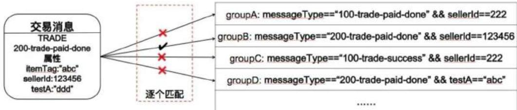
对此流程进行优化的思路需要一定的灵感，在这里借助数据库索引的思路：原有流程可以把所有订阅方的过滤表达式看作数据库的记录，每次消息过滤就相当于一个带有特定条件的数据库查询，把所有匹配查询（消息）的记录（过滤表达式）选取出来作为结果。为了加快查询结果，可以选择 Message Type 作为一个索引字段进行索引化，每次查询变为先匹配 Message Type 主索引，然后把匹配上主索引的记录再进行其它条件（如下图的 sellerId 和 testA）匹配，优化流程如下图所示：
