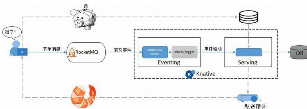
如上图所示，当用餐时间来临，客户点餐生成下单消息发送到 RocketMQ，通过 RocketMQSource 获取下单消息转换成事件发送到 Broker，通过 Trigger 订阅下单事件最终驱动订单服务生成订餐单。采用该方案具有以下优势：
