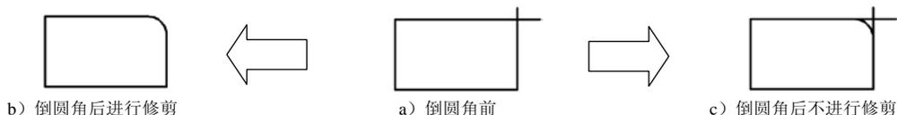
图 6.5.12 倒圆角修剪
