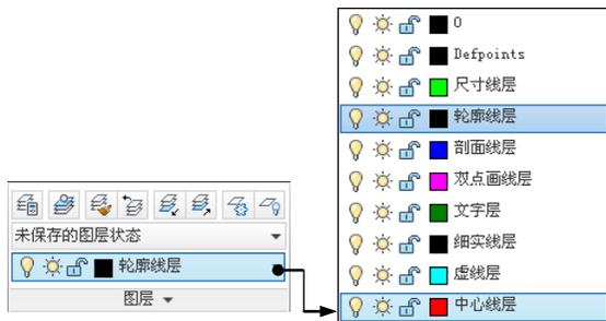
图 3.5.10 “图层”工具栏
