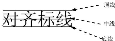
图 7.1.15 调整方式中参照的三条线
