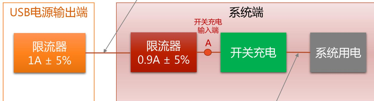
为了此处电压不跌落，要保证A点电压不跌落。如果有深红色模块限流器，系统用电折算到A点电流要小于900mA，而如果没有深红色限流模块，则可增大10%，用满1A电流。
