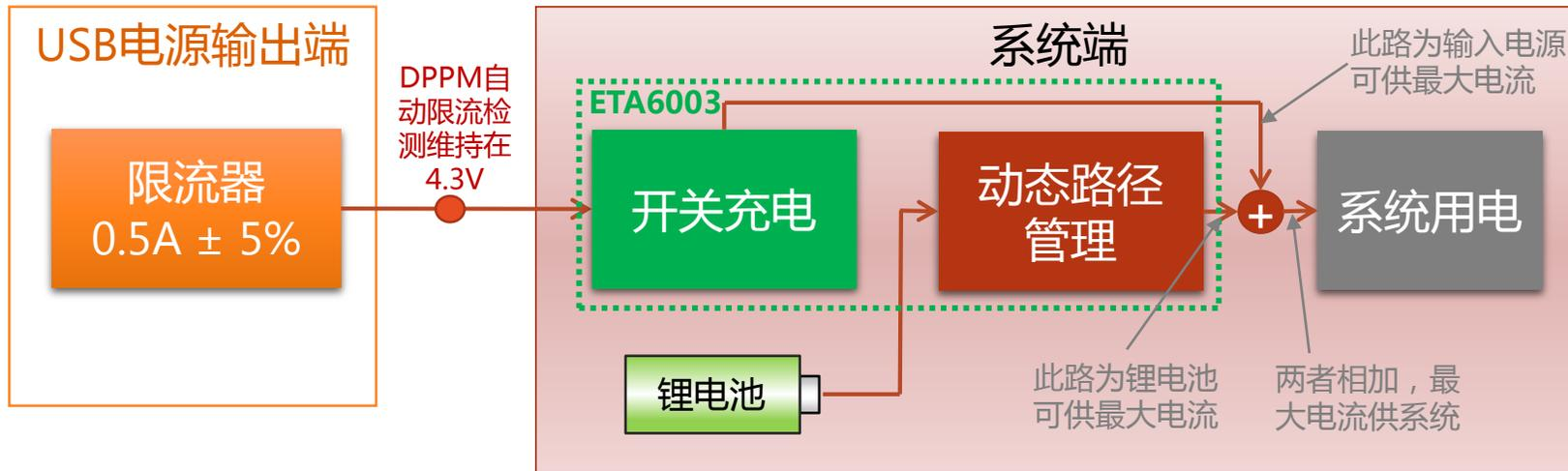
当输入电源的功率本身就小于系统工作需要的功率时，ETA6003的系统供电图
